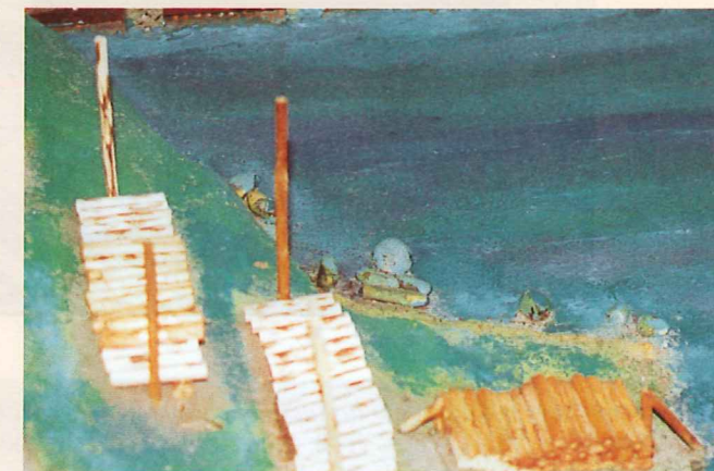
Maquette du bassin de réception avec, à l'arrière, le râtelier destiné à arrêter les bois flottants (Photos A. Jacques)
